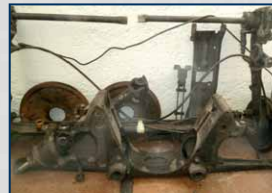
Seltsamer Abschlepphaken an der stark beschädigten Vorderachse.
